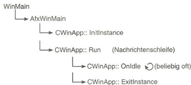
Abbildung 6.6 Ablauf einer MFC-Anwendung 14
