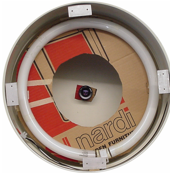
Fig. 6.4 Runde FL im Aufnahmetisch eingebaut
